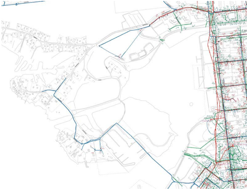
Kuva 6 Raahen Vesi Oy:n linjat Pikkulahden alueella. Jätevesiviemärit on piirretty punaisella viivalla, vesijohtot sinisellä viivalla ja sadevesiviemärit vihreällä viivalla.
